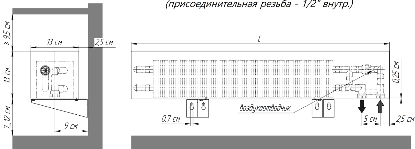
Настенный конвектор "Элегант - мини 130x130-2то Стен прав" с правосторонним нижним подключением (левостороннее - зеркально) (присоединительная резьба - 1/2" внутр.)
