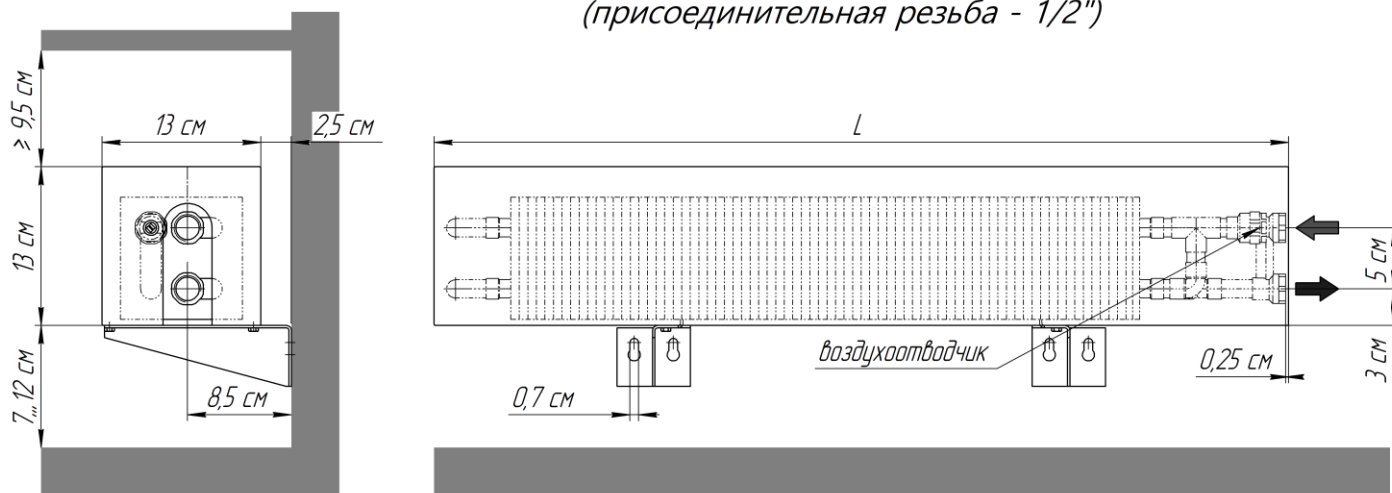
Настенный конвектор "Элегант - мини 130x130-2то бок Стен прав" с правосторонним боковым присоединением (левостороннее - зеркально) (присоединительная резьба - 1/2")
